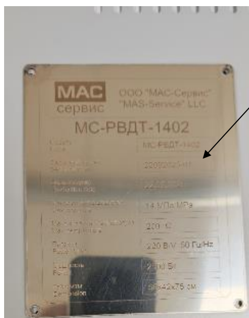
Рисунок 2 – Место нанесения серийного номера на реометры ротационные МС-РВДТ-1402
