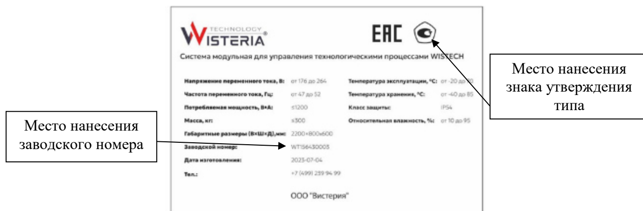
Рисунок 3 – Маркировочная табличка Системы с местом нанесения заводского номера и знака утверждения типа СИ
