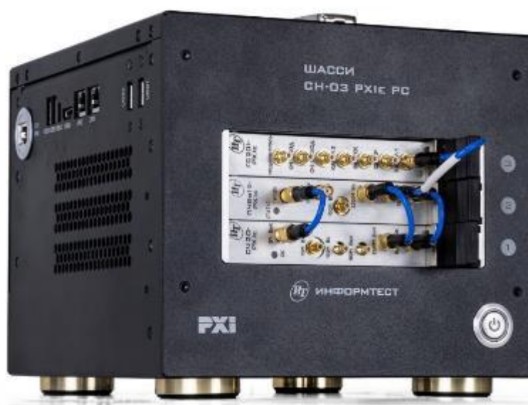
б) Генератор сигналов ГСМ PXIe, установленный в шасси CH-03 PXIe
