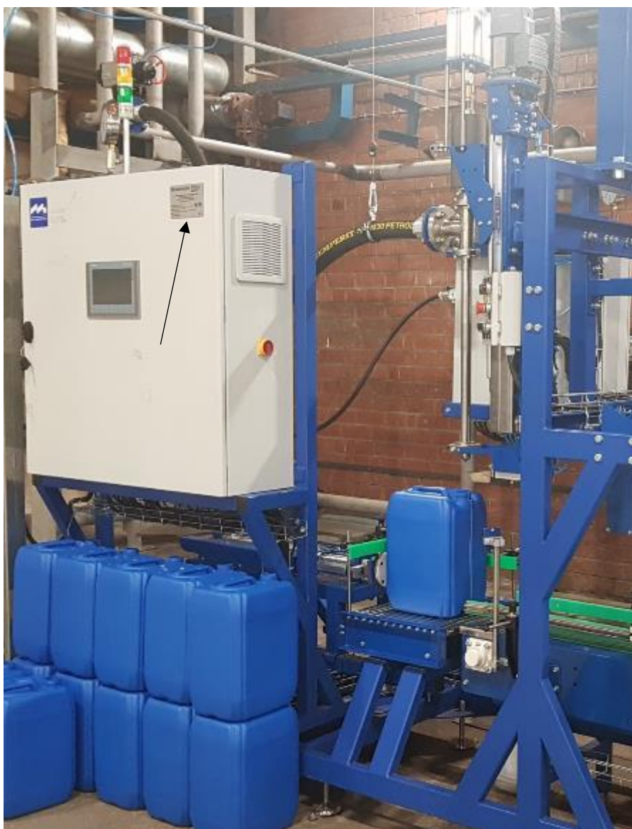
Рисунок 1 – Общий вид дозатора и место нанесения маркировочной таблички со знаком утверждения типа и заводским номером (показано стрелкой)
