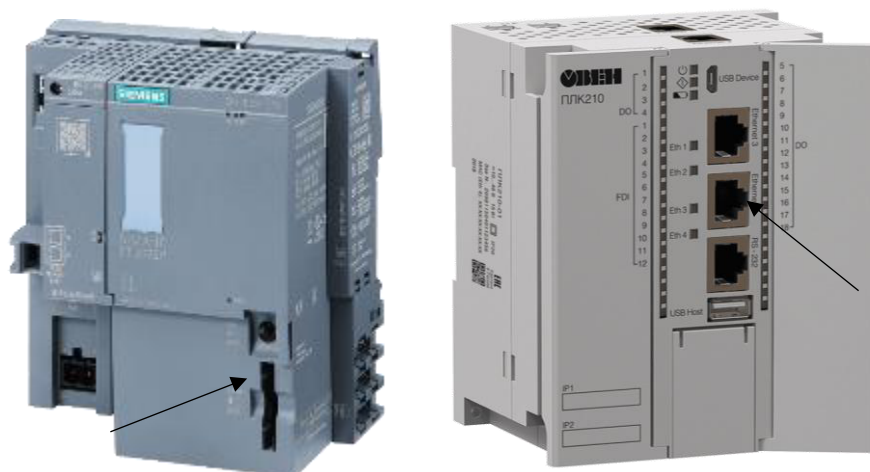
Рисунок 6 – Общий вид ПЛК и место нанесения разрушающейся наклейки (показано стрелкой)
