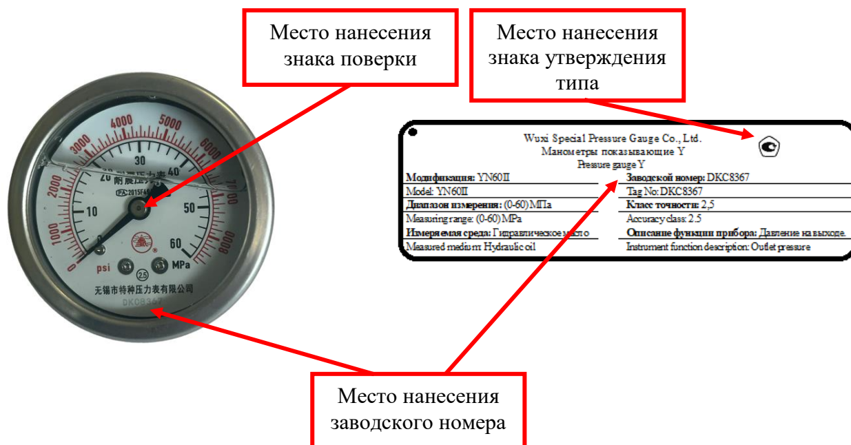
Рисунок 2 – Места нанесения заводского номера, знака утверждения типа и знака поверки
