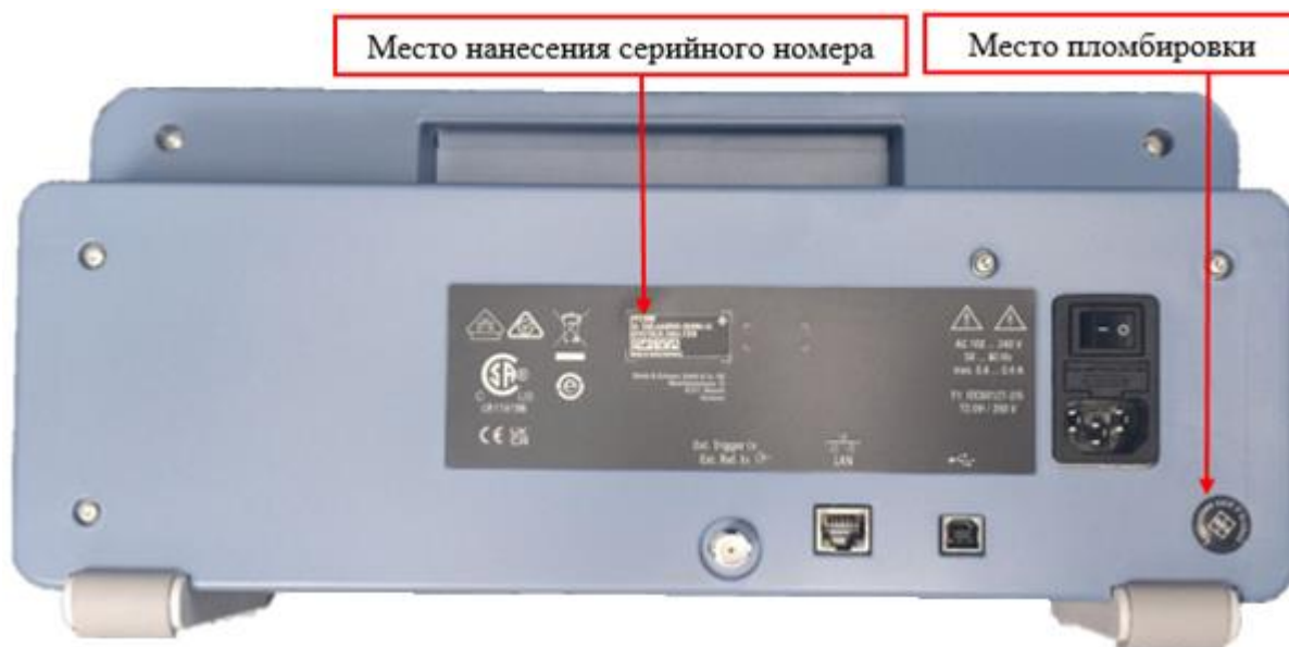
Рисунок 2 – Вид задней панели с указанием мест пломбировки, нанесения серийного номера
