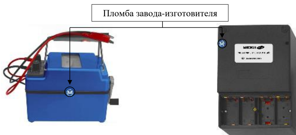
Р и с у н о к 3 – Схема пломбировки от несанкционированного доступа
