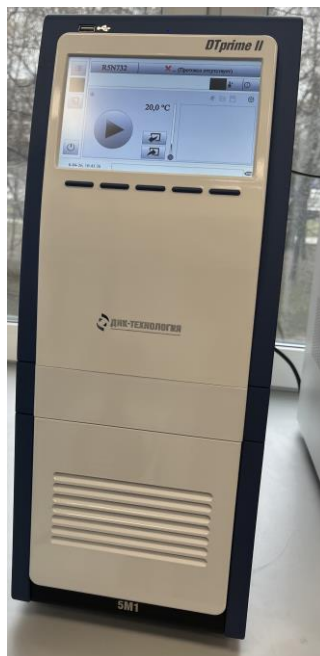
Рисунок 1 – Общий вид амплификаторов детектирующих «ДТпрайм II»
