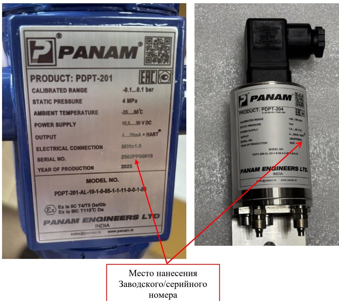
Рисунок 4 – Места нанесения заводского/серийного номера
