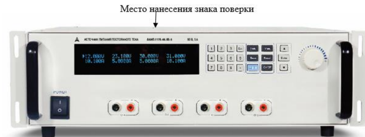
Рисунок 5 – Место нанесения знака поверки источников АКИП-1176-4К-30-5, АКИП-1176-4К-30-10, АКИП-1176-4К-60-3, АКИП-1176-4К-60-5
