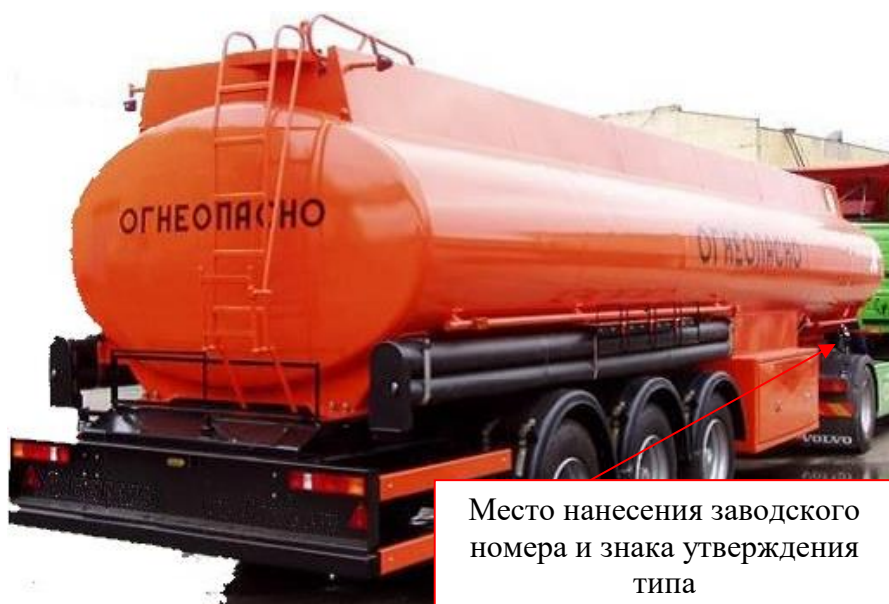
Рисунок 3 – Общий вид ППЦ овального сечения
