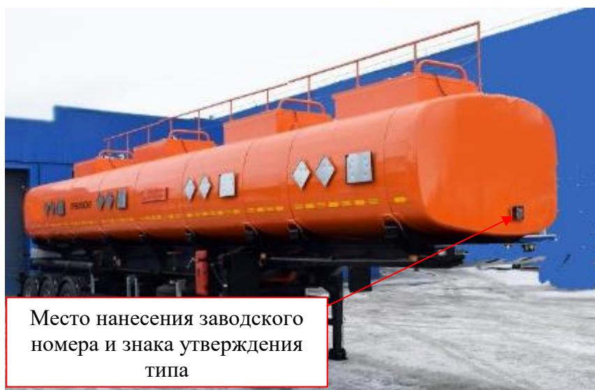
Рисунок 2 – Общий вид ППЦ чемоданного сечения
