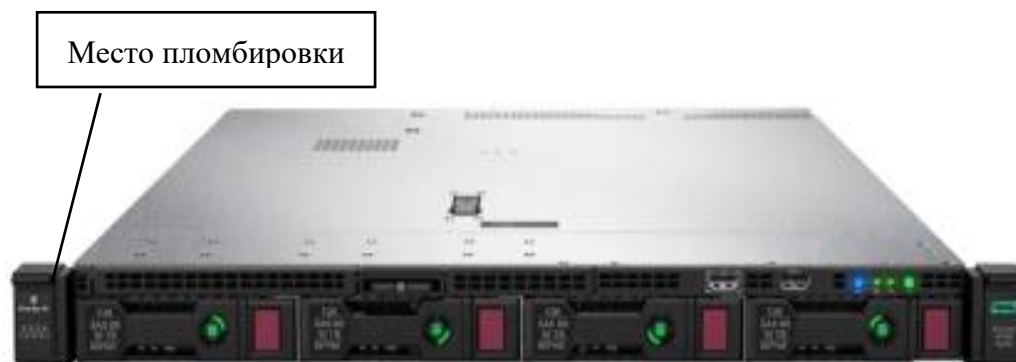
Рисунок 7 – Внешний вид и место пломбировки сервера системы
