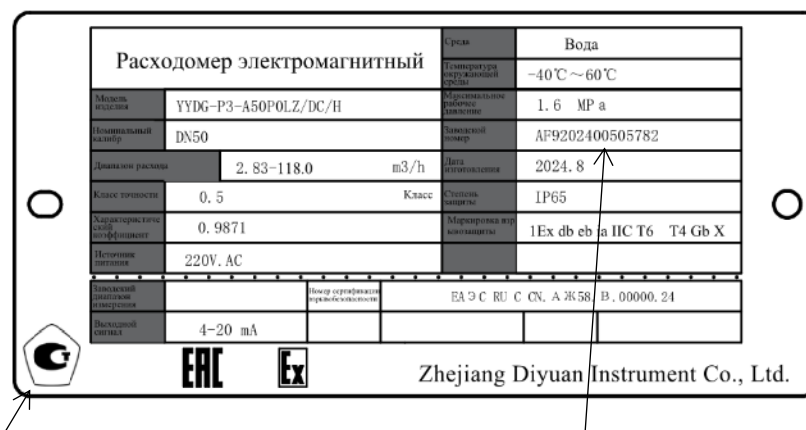
Место нанесения знака утверждения типа Место нанесения заводского номера
