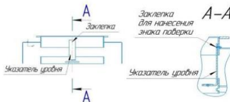
Рисунок 4 – Схема пломбировки от несанкционированного изменения положения указателя уровня налива в горловине цистерны
