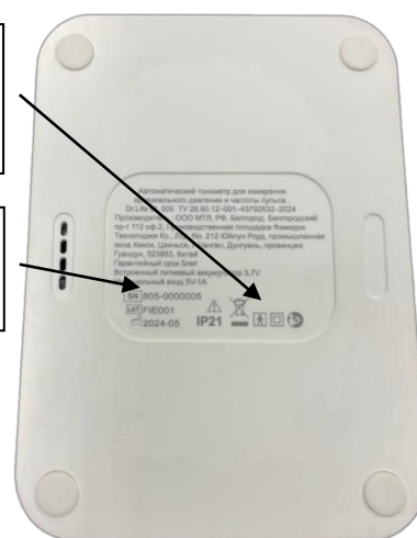
Рисунок 2 – Общий вид тонометров модификаций DL 300, DL 400, DL 500 (в белом цвете корпуса) с указанием мест нанесения серийного номера и знака утверждения типа
