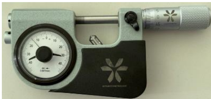
Рисунок 1 – Общий вид микрометров модели 2912
