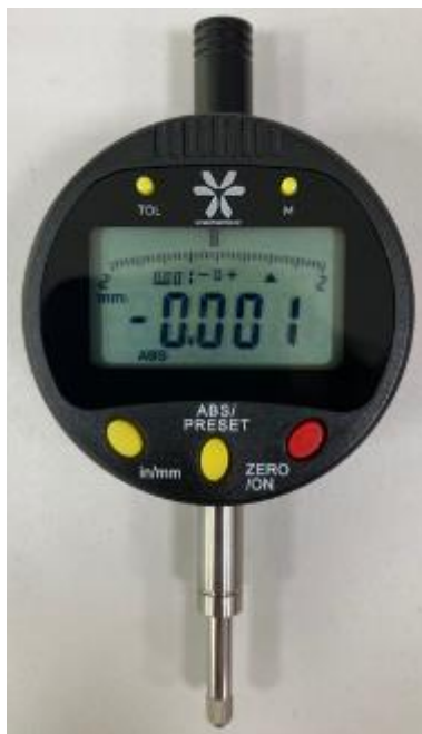
Рисунок 5 – Общий вид индикатора цифрового модификации 7122-10
