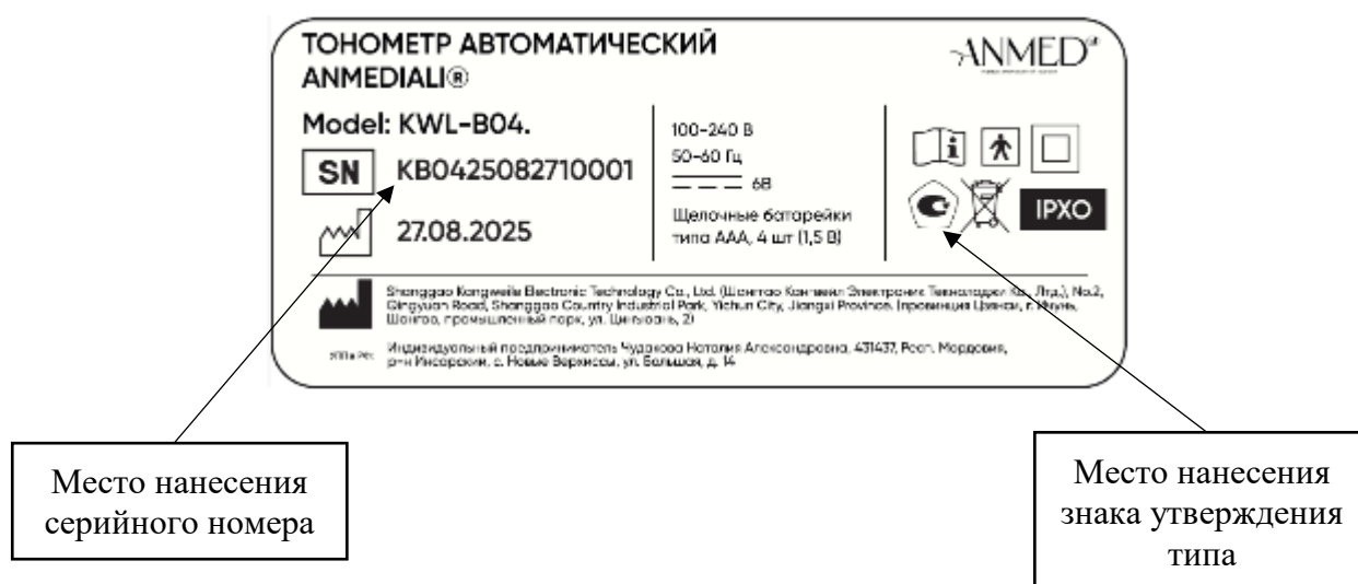
Рисунок 3 – Места нанесения знака утверждения типа и серийного номера
