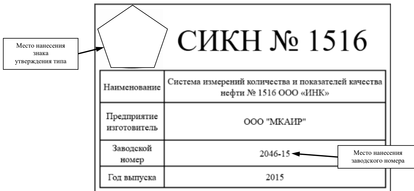
Рисунок 1 – Места нанесения заводского номера и знака утверждения типа
