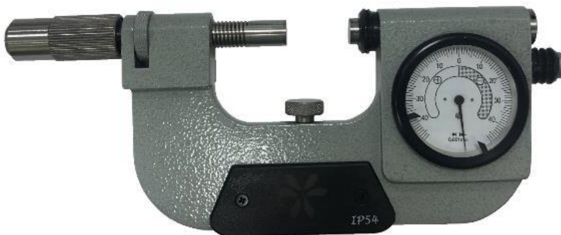
Рисунок 2 – Общий вид скоб модели 7511, модификаций 7511-50, 7511-75, 7511-100
