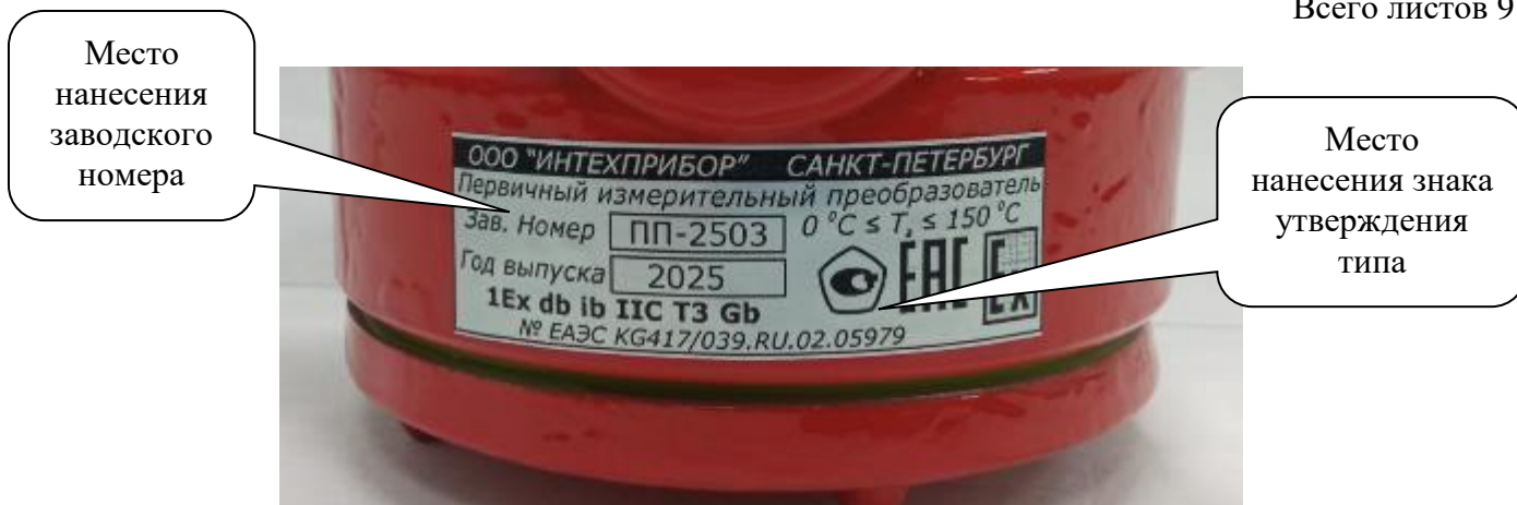
Рисунок 6 – Общий вид маркировочной таблички с указанием места нанесения заводского номера ПИП
