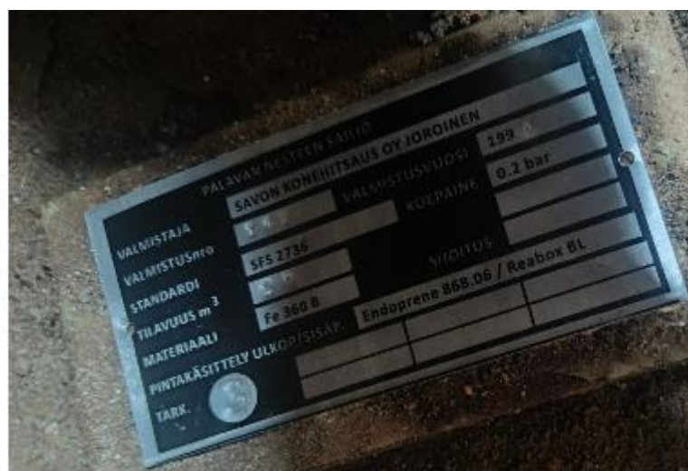
Рисунок 4 – Маркировочная табличка и горловины резервуара РГС-50 зав.№ 148
