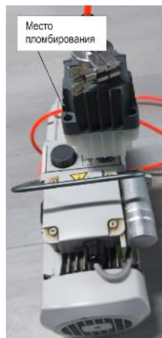
Пломбирование установки контроля вакуума УКВ03
