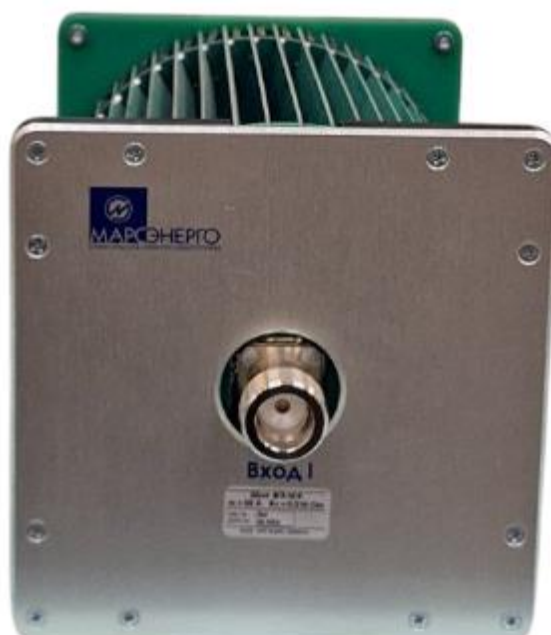
Рисунок 2 – Общий вид шунта ШЭ-50.0
