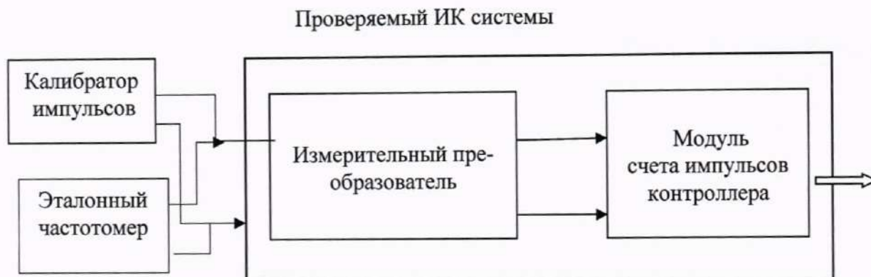
Рисунок 3 - Схема проверки погрешности каналов счета импульсов системы
