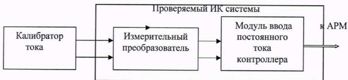
Рисунок 1 - Схема проверки погрешности каналов измерения силы постоянного тока системы
