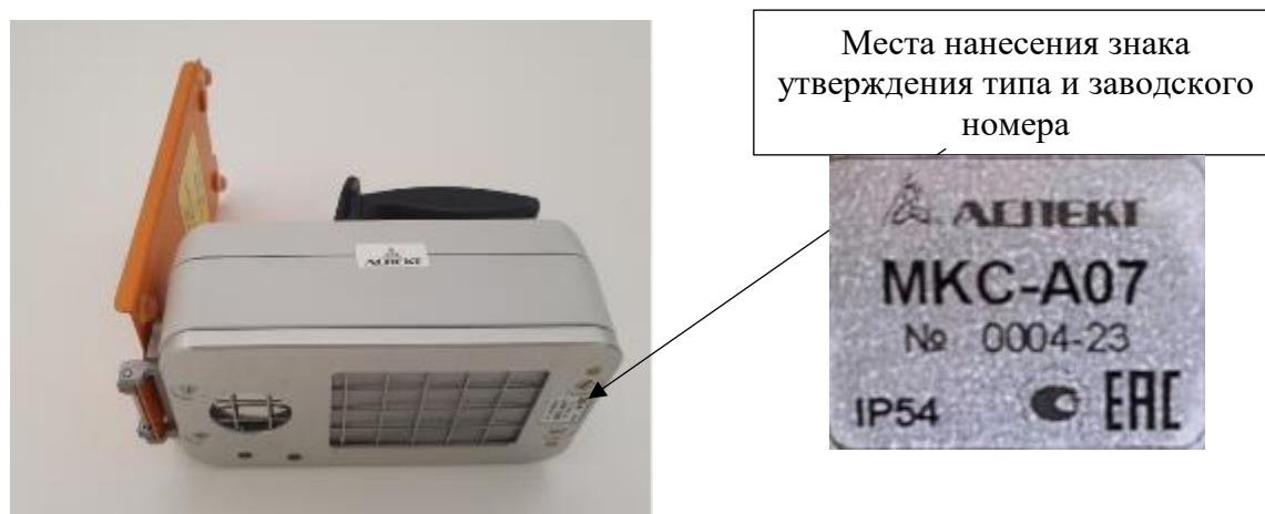
Рисунок 2 – Общий вид МКС-А07 с указанием мест нанесения знака утверждения типа и заводского номера
