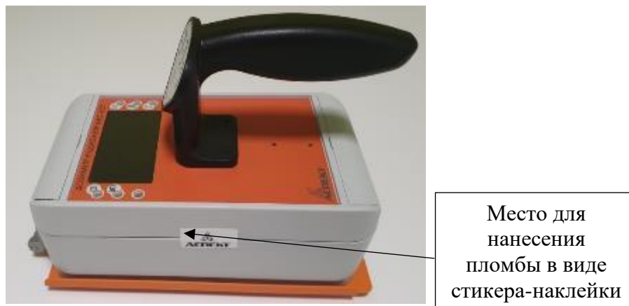
Рисунок 1 – Общий вид МКС-А07 с указанием места пломбирования
