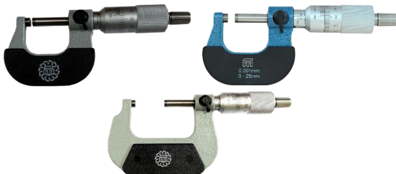
Рисунок 3 – Общий вид микрометров с отсчетом показаний по шкалам стебля и барабана с нониусом
