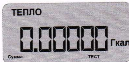
Рисунок 5 – Жидкокристаллический дисплей при отображении тепловой энергии в меню А4 «ТЕСТ»
