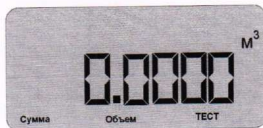
Рисунок 3 – Отображение накопленного значения объема в расширенном формате меню A4 «ТЕСТ»
