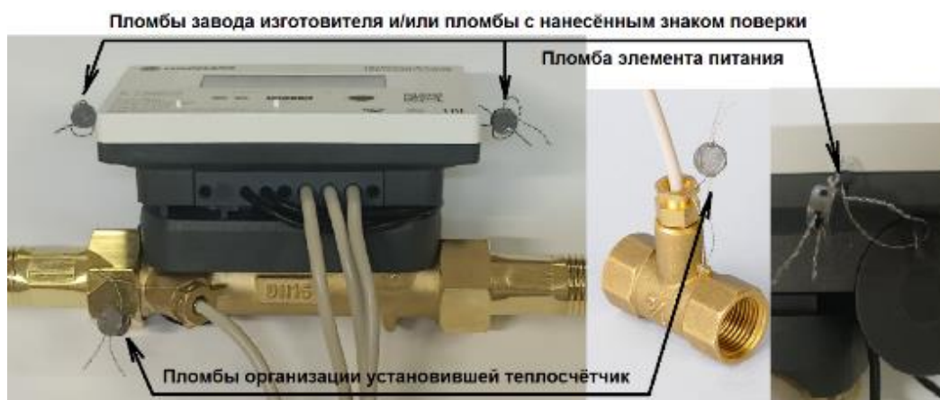
Рисунок 2 – Схема пломбировки теплосчетчика
