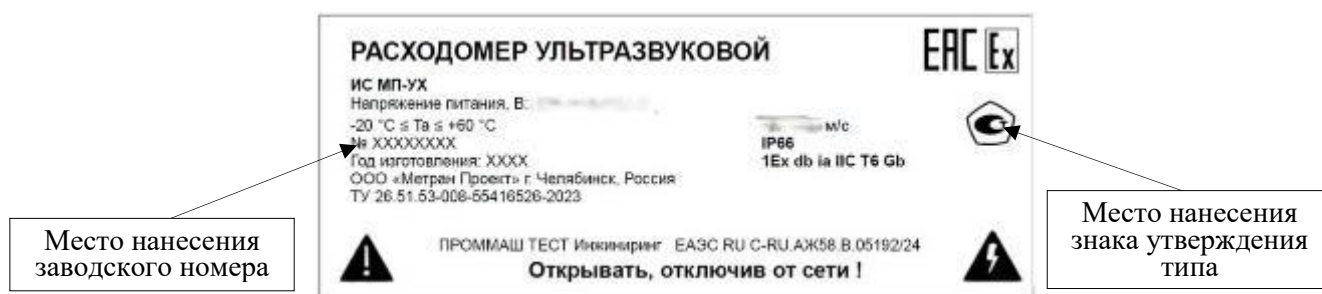
Рисунок 2 – Общий вид (схема) информационной таблички с указанием места нанесения заводского номера знака утверждения типа
