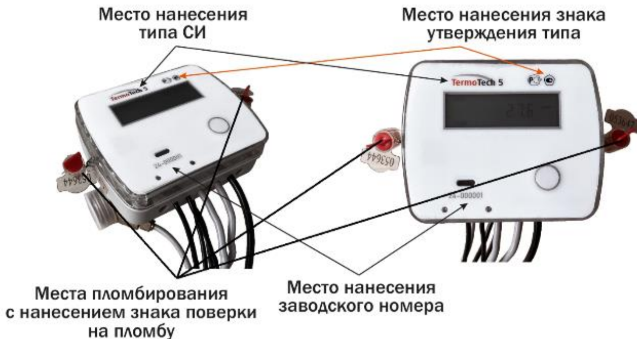
Рисунок 2 – Схема пломбировки от несанкционированного доступа, обозначение мест нанесения знака поверки, знака утверждения типа и заводского номера
