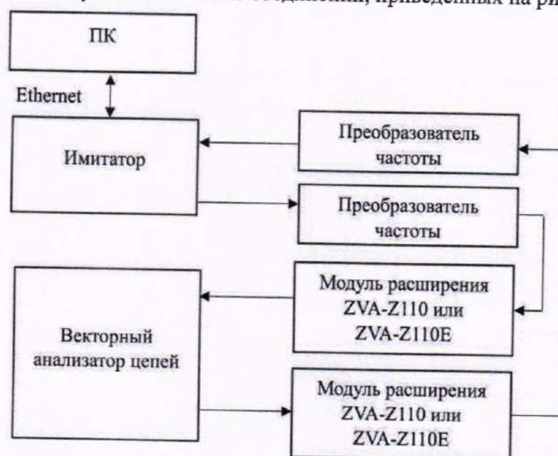
Рисунок 2 – Схема подключения имитаторов при определении диапазона воспроизведения дальности до цели
