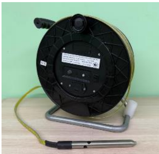
Рисунок 1 – Общий вид устройства измерительного электроконтактного Анаконда ЭКУ модификации ЭКУ-М
