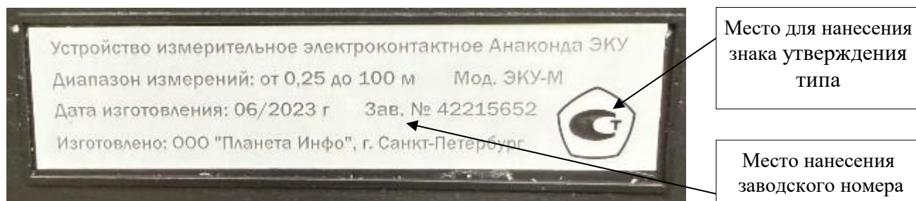
Рисунок 3 – Маркировочная табличка устройства измерительного электроконтактного Анаконда ЭКУ модификации ЭКУ-М с указанием места нанесения знака утверждения типа и заводского номера
