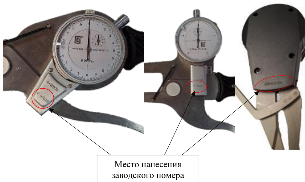
Рисунок 13 – Места нанесения заводского номера
