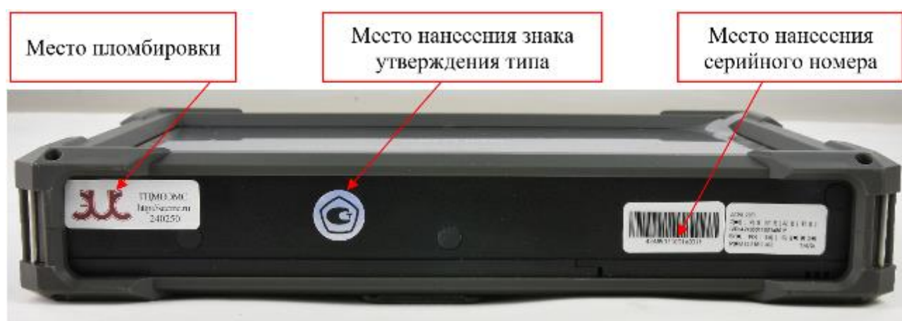
Рисунок 7 – Место нанесения знака утверждения типа, схема пломбировки от несанкционированного доступа и место нанесения серийного номера, идентифицирующего каждый экземпляр средства измерений
