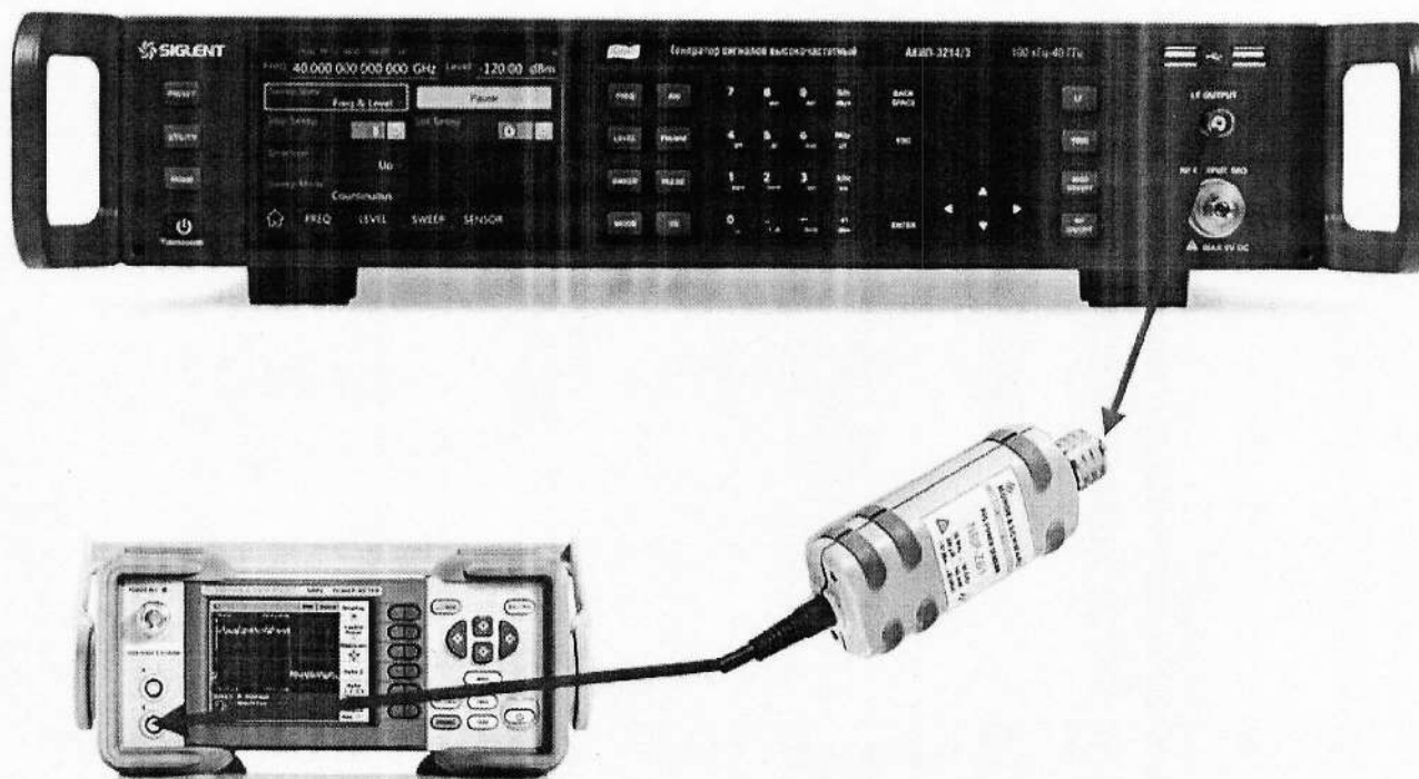
Рисунок 6 – Схема соединения приборов для определения неравномерности АЧХ встроенного НЧ генератора
