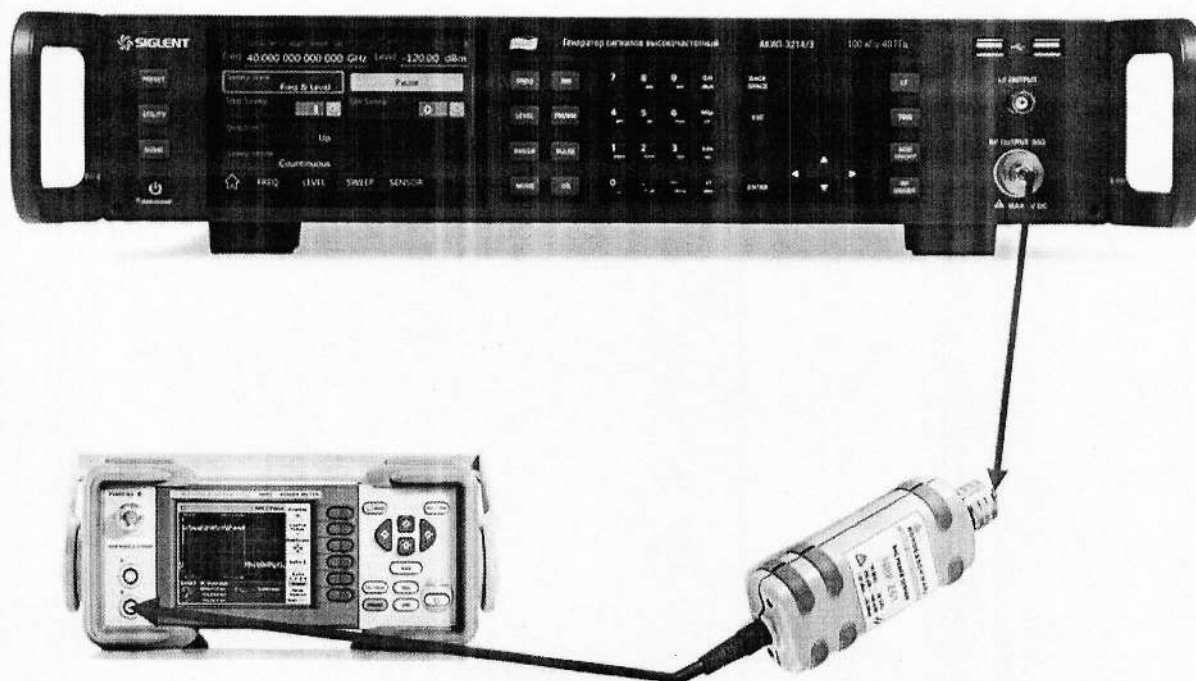
Рисунок 1 – Схема соединения приборов для определения погрешности установки выходного уровня генератора в диапазоне уровней от +20 до 0 дБм
