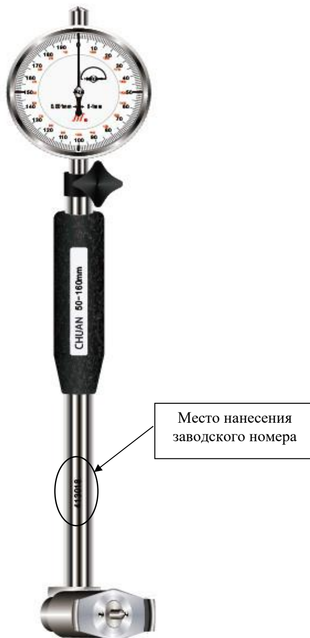
Рисунок 2 – Общий вид нутромеров модели НИ-ПТ с указанием места нанесения заводского номера
