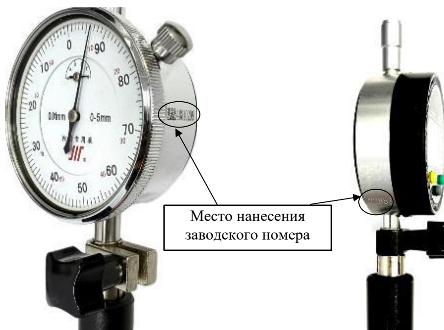
Рисунок 5 – Места нанесения заводских номеров на отсчетное устройство
