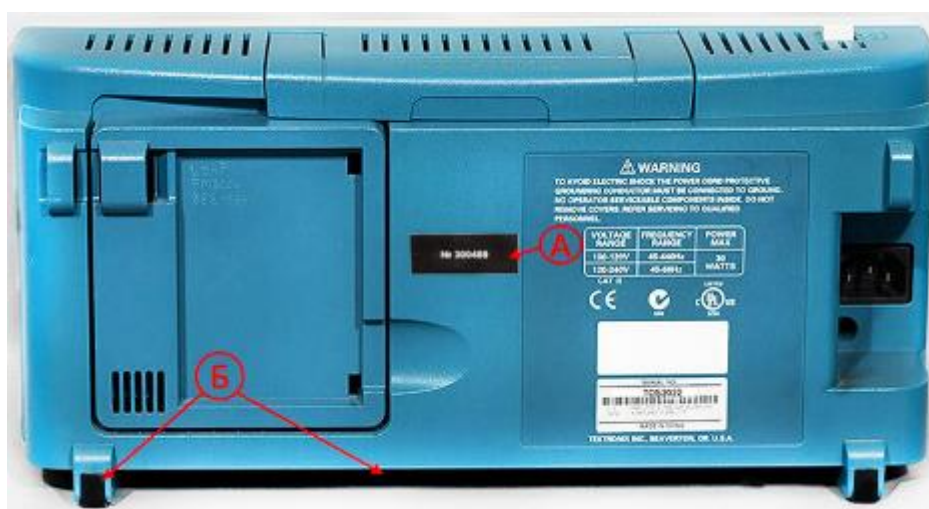
Рисунок 2 – Вид задней панели осциллографа цифрового TDS2022 с указанием: А) места нанесения заводского номера; Б) мест для пломбирования от несанкционированного доступа
