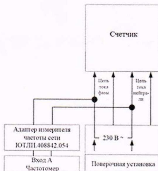
Рисунок 2– Схема определения абсолютной погрешности измерений переменного тока с применением частотомера
