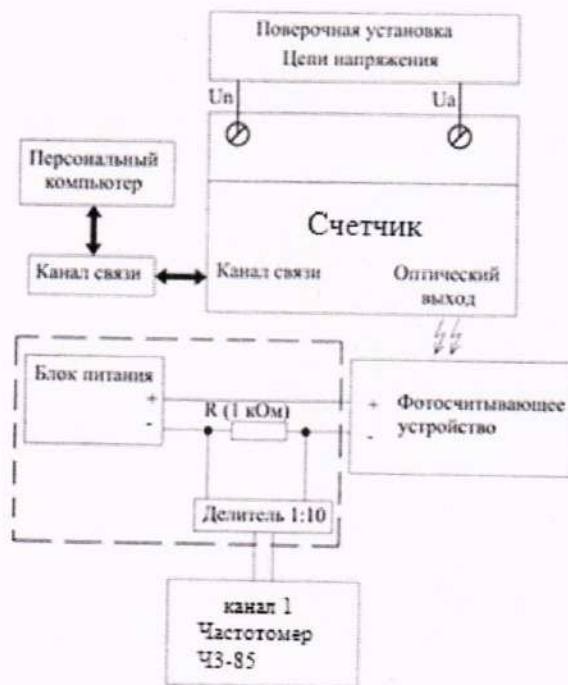
Рисунок 3 – Схема подключения счетчика при определении абсолютной погрешности суточного хода часов
