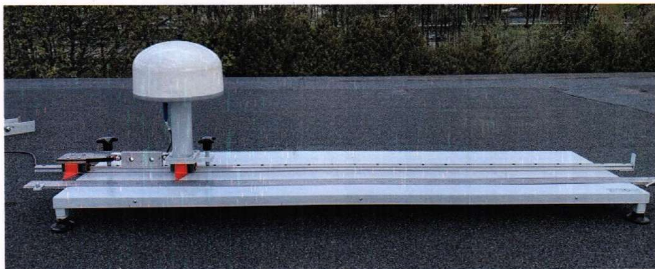
Рисунок 1 – Определение погрешности измерений по высоте
