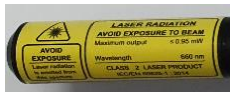
Рисунок 4 – Место нанесения маркировочной таблички с характеристиками лазера
