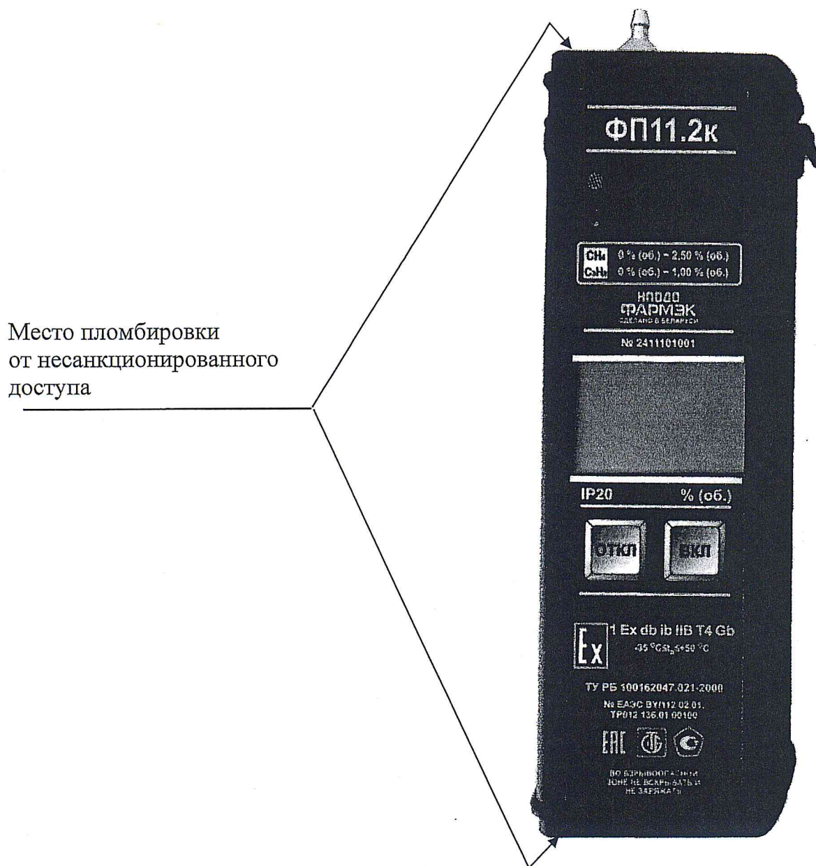
Рисунок 3.1 – Схема пломбировки от несанкционированного доступа
