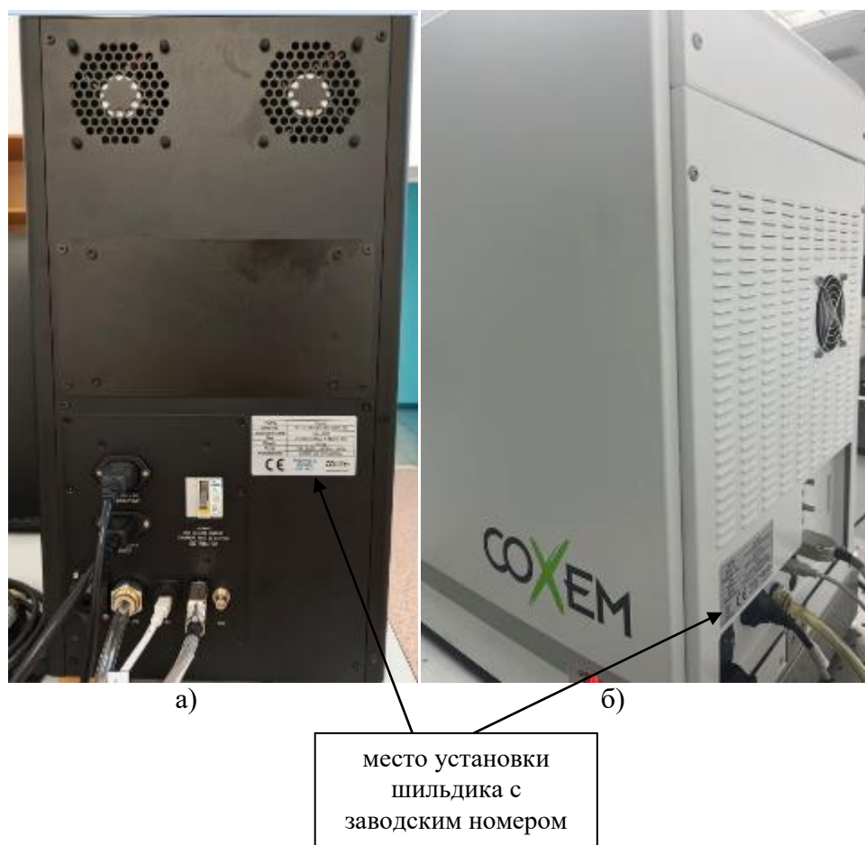
Рисунок 3 – Место установки шильдика с заводским номером микроскопов модификации ЕМ-40 (а) и модификаций ЕМ-30N+, ЕМ-30AXN+ (б)
