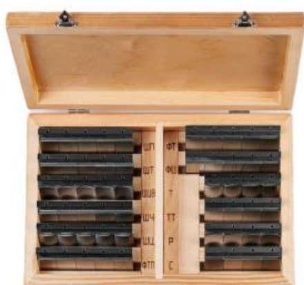
Рисунок 1 – Общий вид образцов шероховатости (сравнения) РИК
