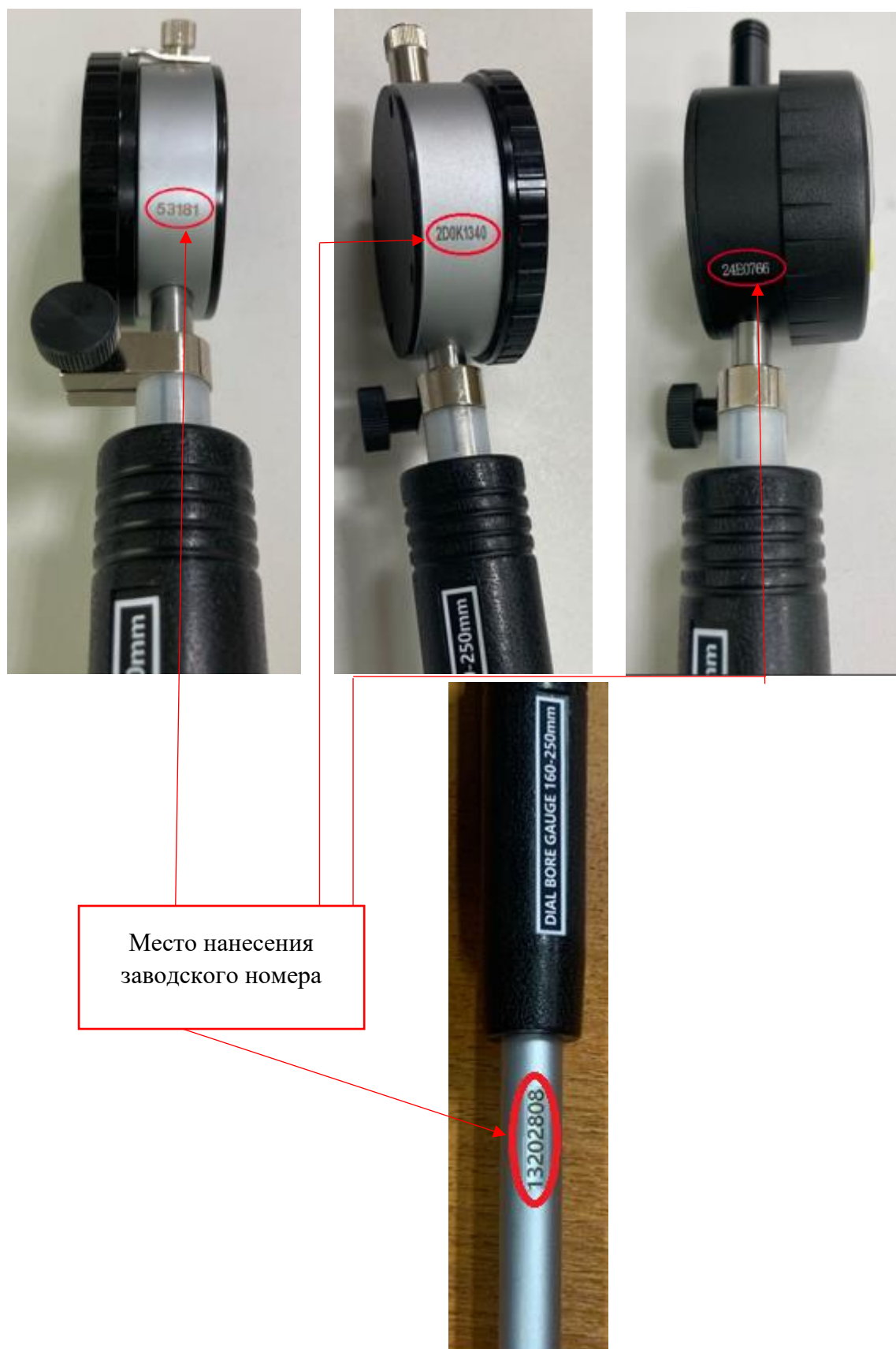
Рисунок 18 – Возможные места нанесения заводского номера
