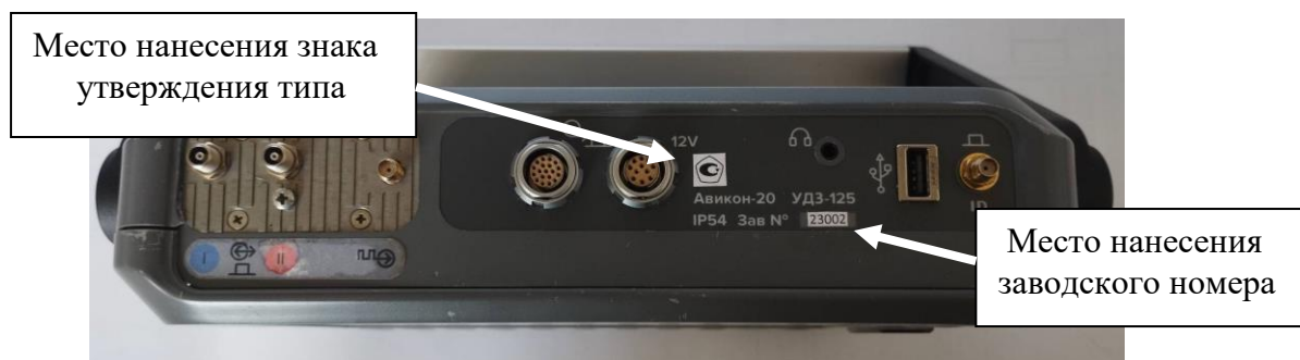
Рисунок 2 – Места нанесения заводского номера дефектоскопа и знака утверждения типа
