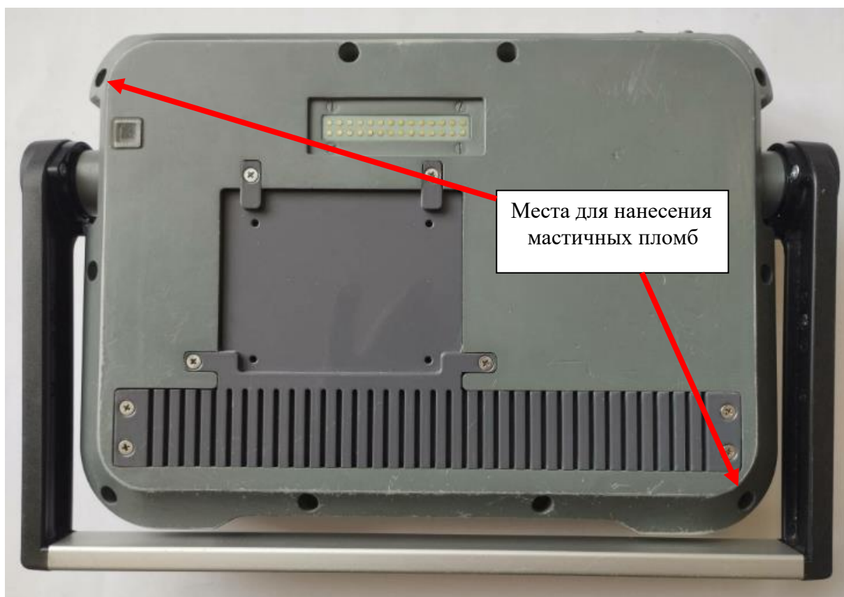
Рисунок 3 – Места нанесения пломб
