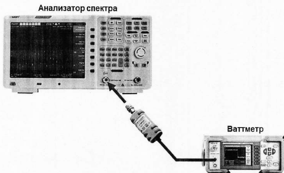
Рисунок 6 – Схема соединения приборов для определения абсолютной погрешности установки опорного уровня следящего генератора
