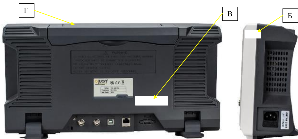
Рисунок 2 – Схема пломбировки от несанкционированного доступа (Б), место нанесения заводского номера (В) и знака поверки (Г).
