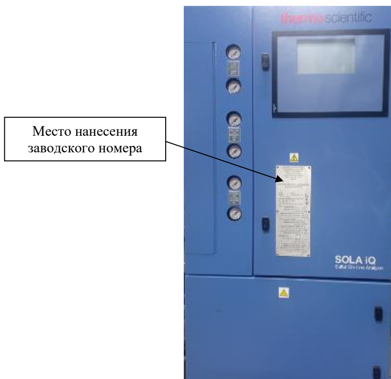
Рисунок 1 – Общий вид анализатора общей серы в нефтепродуктах промышленного SOLA iQ
