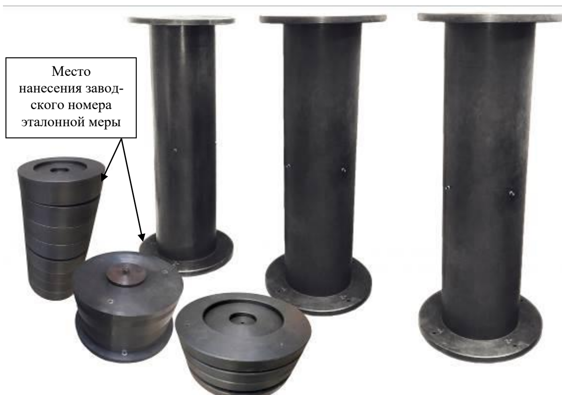
Рисунок 1 – Общий вид эталонных мер типа «Сегмент», «Гиря 50», «Гиря» 140», «Стойка с гирями 100 и 115», используемых для воспроизведения координат центра масс
