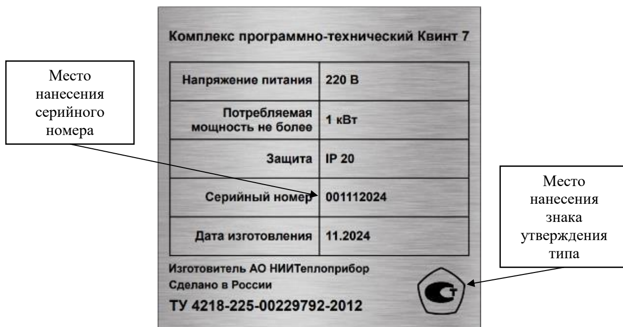
Рисунок 4 – Маркировочная табличка комплексов с обозначением мест нанесения серийного номера и знака утверждения типа
